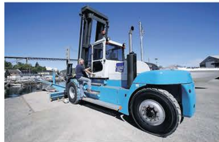
FORSTERKNING: Stathelle Marina har også investert i en ny løftekran som kan løfte opptil 16 tonn.
